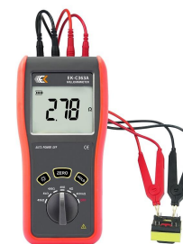
变压器线阻测量
